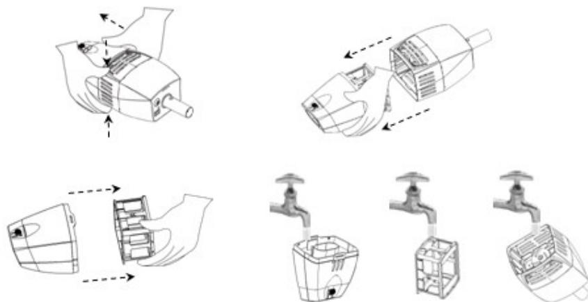
**DE** Installation des Saugkopfes/ **EN** Installation of the suction head/ **E** Installation de la tête d'aspiration/ **ES** Instalación del cabezal de aspiración/ **IT** Installazione della testa di aspirazione/ **PT**
