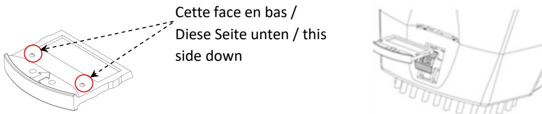
DE Reinigung des Filters/ EN filter cleaning/ F Nettoyage du filtre/ ES limpieza del filtro/ IT pulizia del filtro/ PT Limpeza do filtro/ NL Het filter reinigen/ SE Rengöring av filter/ RO Curățarea filtrului.
