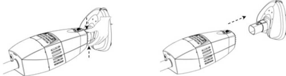
DE Einbau des Rosts für den Abfluss/ EN Installation of the exhaust grille/ F Installation de la grille d'évacuation/ ES Instalación de la rejilla de evacuación/ IT Installazione della griglia di evacuazione/ PT Instalação da grelha de evacuação/ NL Montage van het uitlaatrooster/ SE Installation av avgasgrillen/ RO Instalarea grilei de evacuare.
