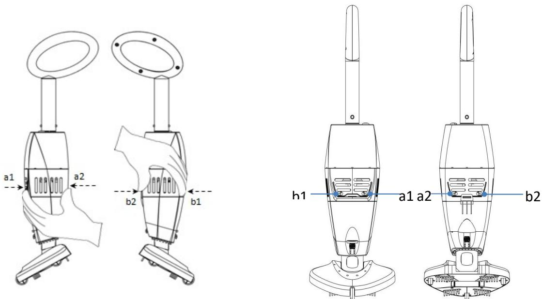
DE Drücken Sie gleichzeitig die Knöpfe a1 und a2 oder b1 und b2, um den Behälter zu öffnen
