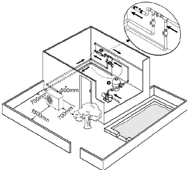
2) De kast van de pomp moet op een betonnen basis bevestigd worden met moeren (M10) of hoekijzers. De betonnen fundering moet stabiel en solide zijn, de hoekijzers moeten met een antiroestmiddel worden behandeld.
