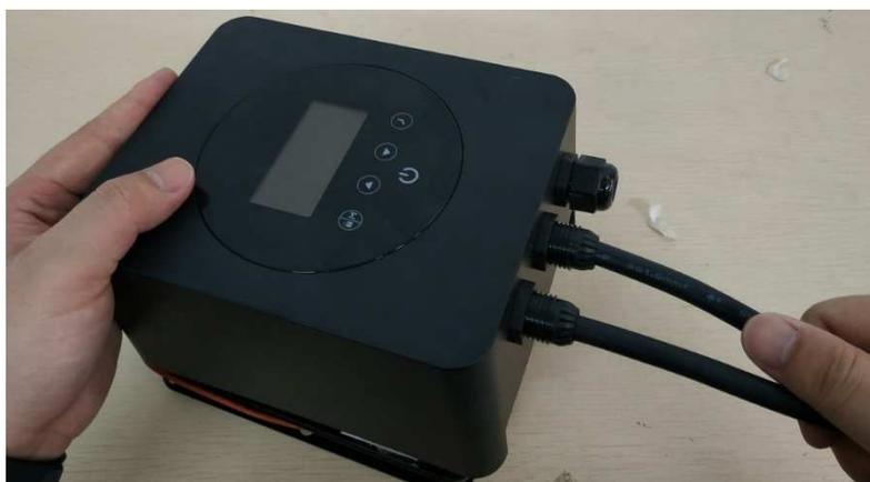
4. Emboîter la face avant en appliquant un effort de haut en bas. L'écrasement du joint d'étanchéité oppose une résistance. S'arrêter au niveau du radiateur :
