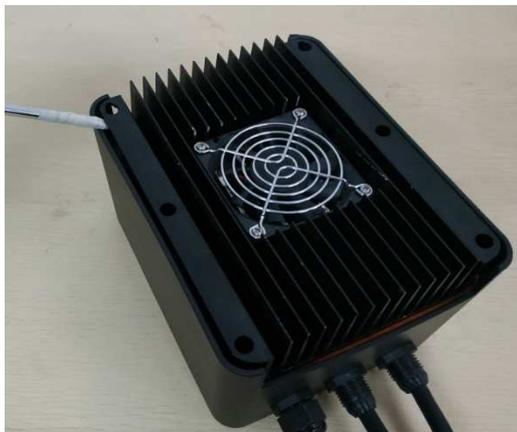
4. Retourner le régulateur et soulever la face avant du boîtier tout en poussant les câbles vers l'intérieur :
