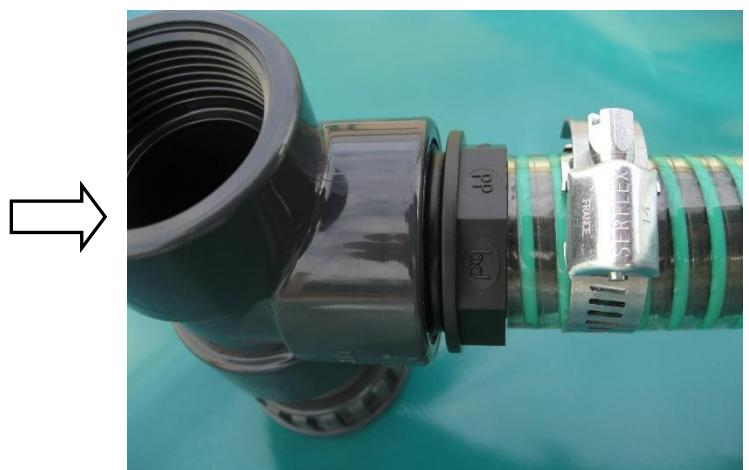
**Schritt 5:** Montieren Sie den Schlauch mit der Schlauchschielle am Verteiler.
