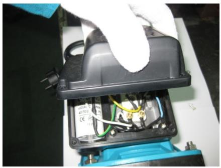
Remettre le couvercle à sa place d'origine / Put the cover back to the original place / Setzen Sie die Abdeckung wieder in ihre Ausgangsposition zurück.
